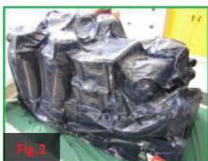
Fig.2 Fase di realizzazione del 'vuoto'
